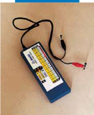
Medición de la humedad de los resecados confeccionados con Mapecem con higrómetro electrónico MAPEI
