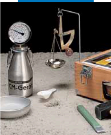
Medición de la humedad del resecado confeccionado con Mapecem con higrómetro de carburo
